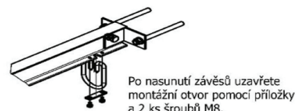
DETAIL B MONTÁŽ ZÁVĚSU ŠPLHOVÉHO LAN/TYČE
